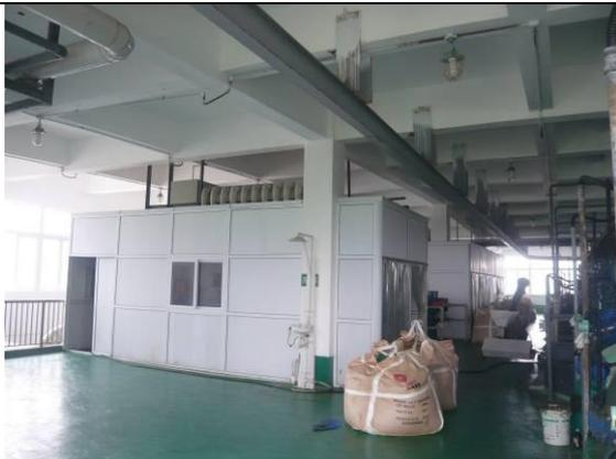
压滤机废气收集
